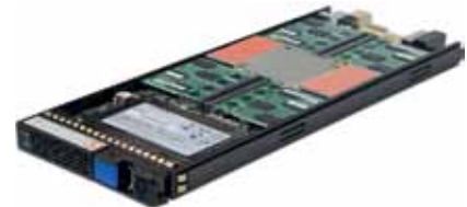
Рис. Модуль FMD второго поколения вмещает до 3,2 ТБ данных на SSD-дисках
